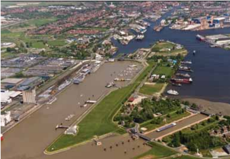
Afb. 5.10: In de Emdener buitenhaven scheiden de sluisen het water van de Eems, dat relatief veel zwevende stof bevat, van het heldere binnenwater in de haven. (Bron: Niedersachsen Ports); rechts: hoge zwevende stof concentraties kleuren het water van de Beneden-Eems bruin.
