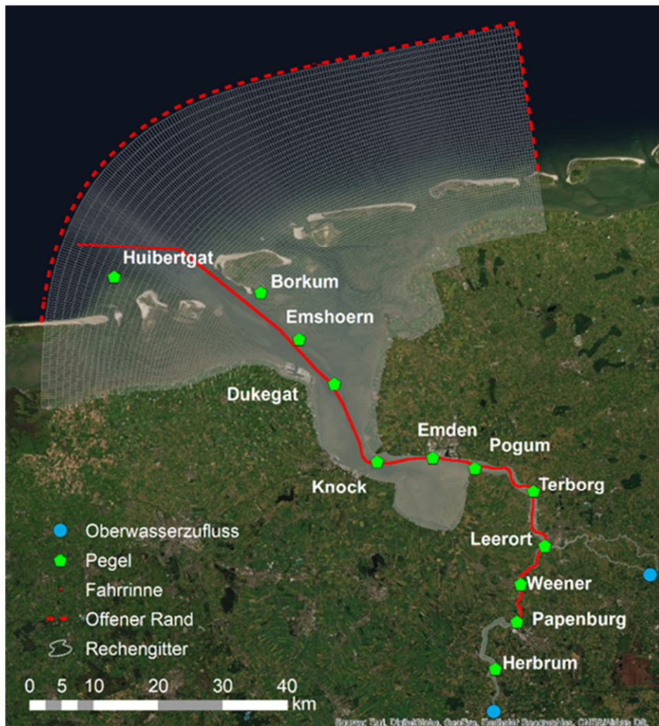
Abbildung 48: Modellgitter des Ems-Ästuar-2015 Modells mit den seeseitigen Modellrand und Abfluss Positionen.
